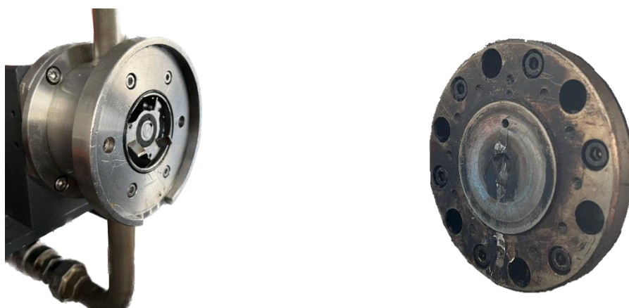
Obr. 12 Rotační část nožové hlavy (vlevo) a vytlačovací hlava (vpravo)
