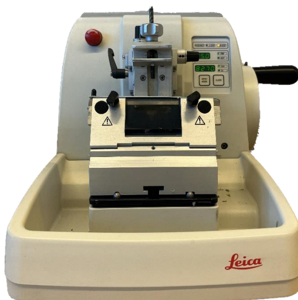
Obr. 22 Rotační mikrotom Leica RM 2255
