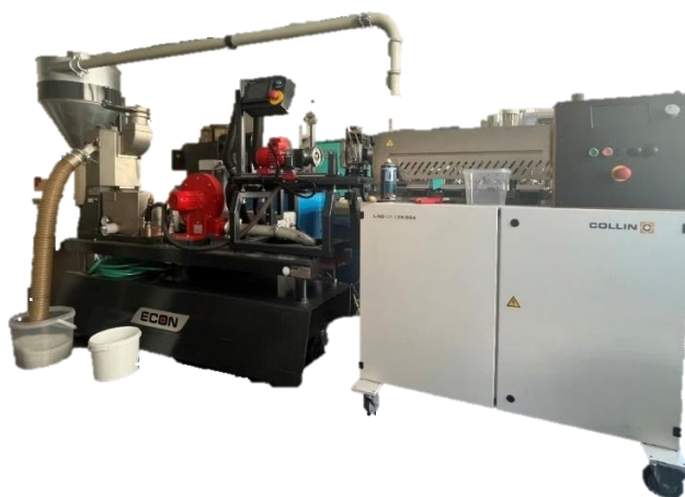
Obr. 11 Granulační jednotka ECON EWT10 (vlevo) a extrudér Collin ZK25E (vpravo)
