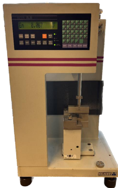
Obr. 41 Zkušební zařízení pro stanovení rázové houževnatosti Charpy Resil Ceast 5.5
