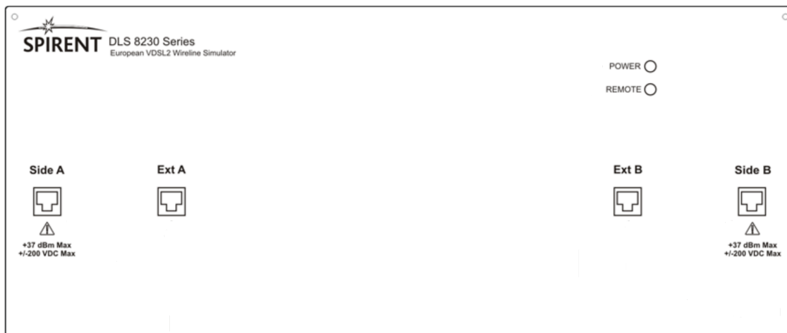
Obr. 2.3: Čelní panel simulátoru DLS 8234
