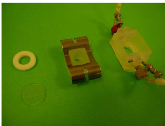
Obr. 15: Rozložená penetrační cela.
