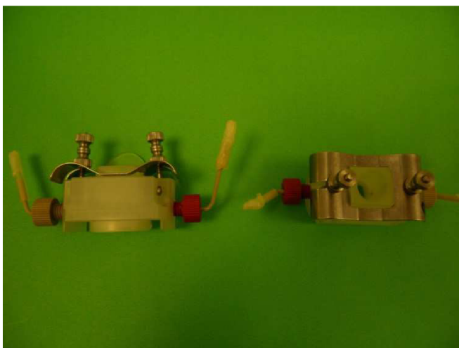
Obr. 16: Zkompletovaná penetrační cela; pohledu z boku a shora.
