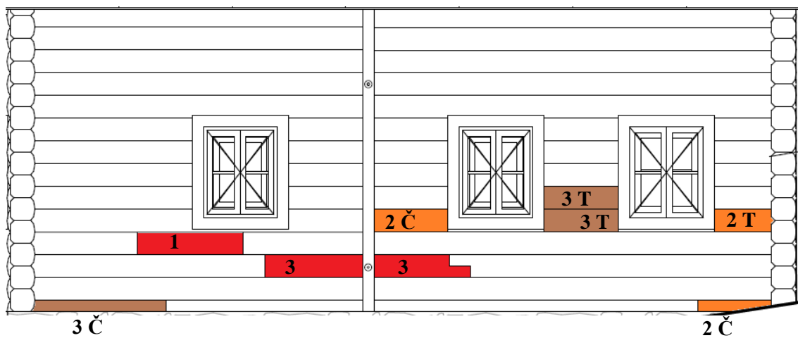
Obr. 50 Rozsah napadení jižní stěny škůdci (vlastní zpracování na základě podkladů z absolvovaného hlavního cvičení v 2016, doměření hodnot a vlastního vyhodnocení)
