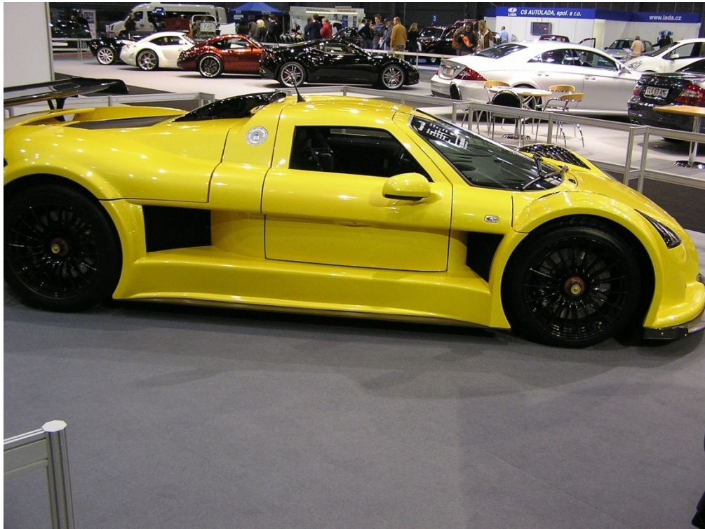
Obrázek 23: nalakovaná karoserie z kompozitního materiálu
