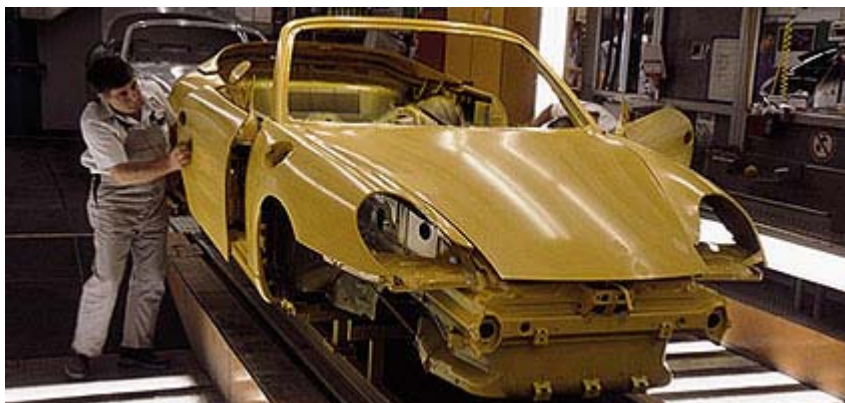
Obrázek 24: Porsche 911 carrera- oprava drobných nedostatků jemným broušením[9]
