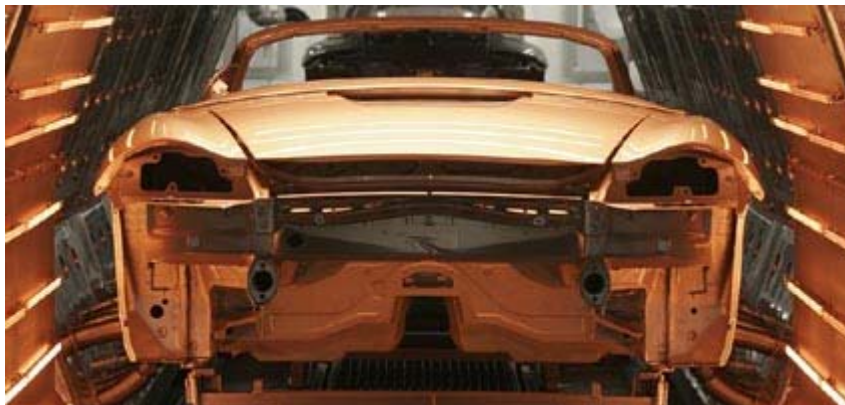
Obrázek 18: tvrzení laku v infračervené sušičce[9]
