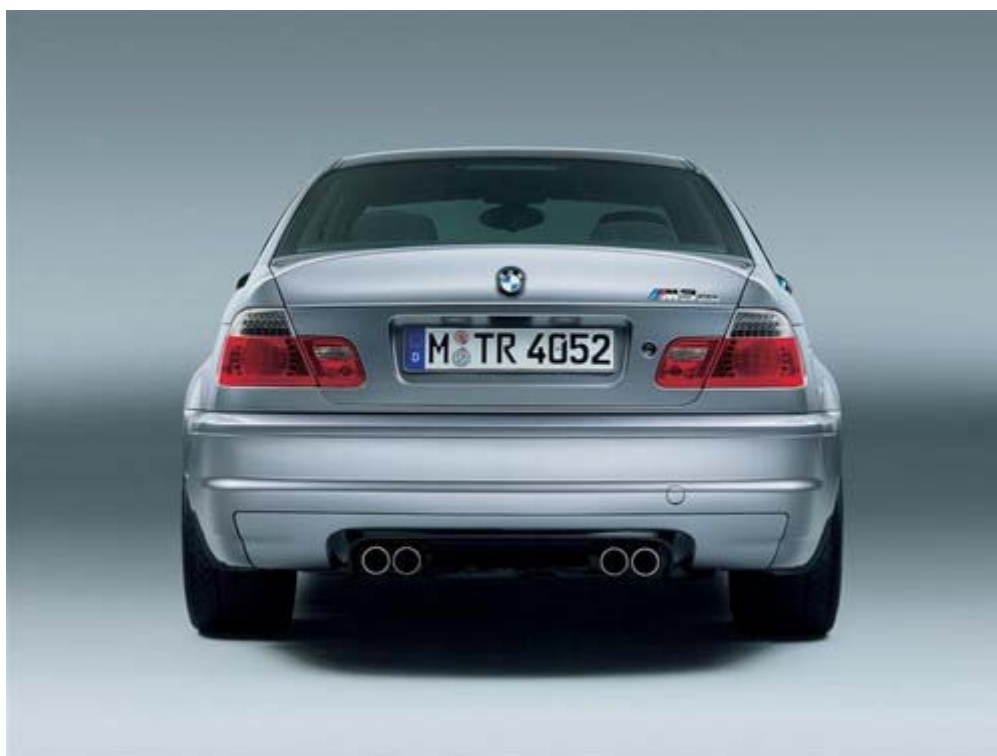
Obrázek 22: BMW M3- zadní nárazník je vyroben z polypropylenu
