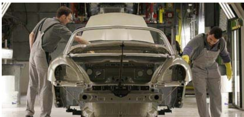
Obrázek 25: manuální prověření kvality laku[9]
