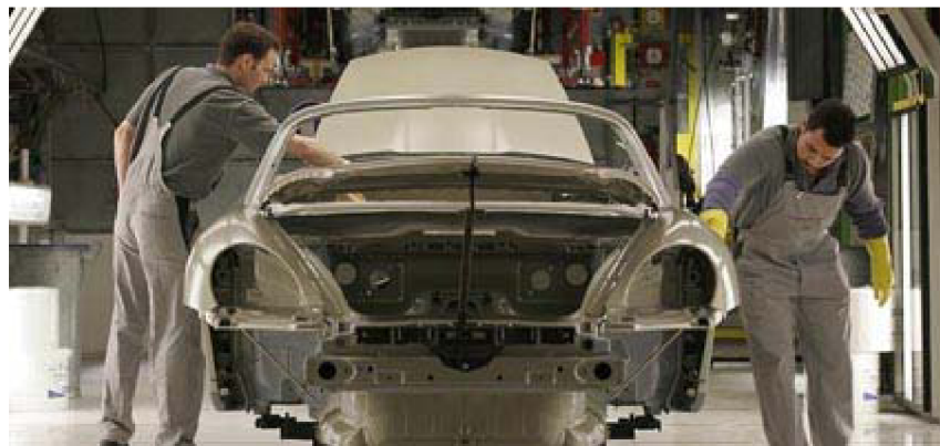
Obrázek 25: manuální prověření kvality laku[9]
