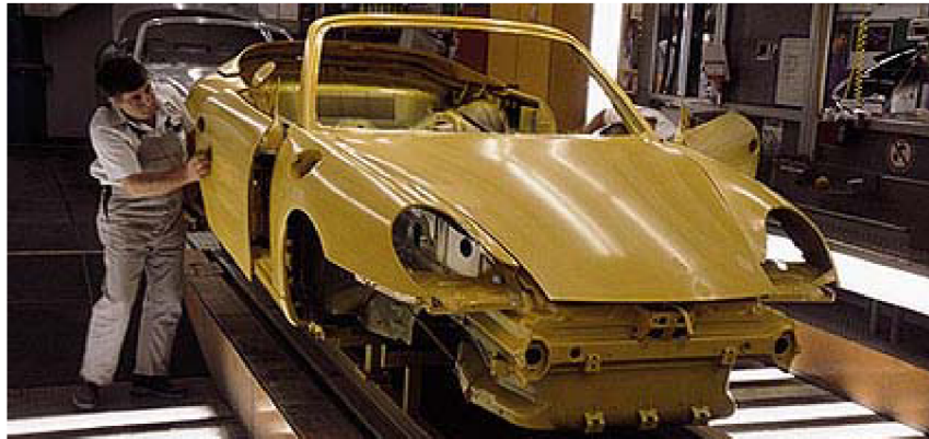
Obrázek 24: Porsche 911 carrera- oprava drobných nedostatků jemným broušením[9]
