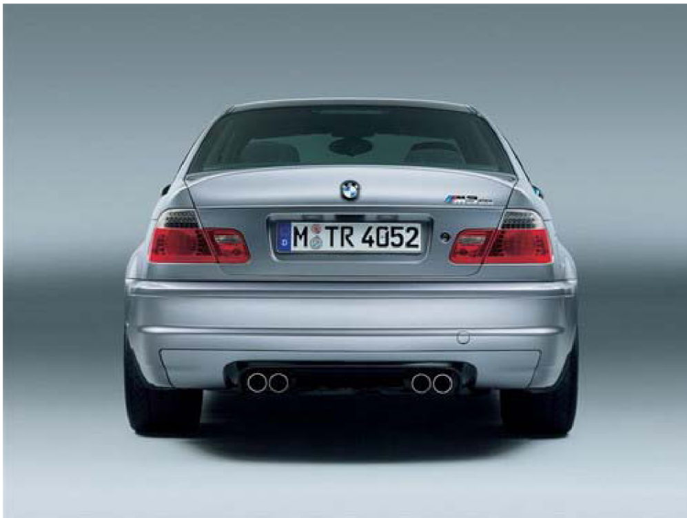
Obrázek 22: BMW M3- zadní nárazník je vyroben z polypropylenem
