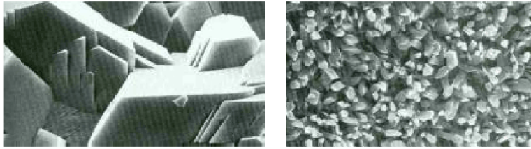
Obrázek 2: struktura fosfátované vrstvy [3]
