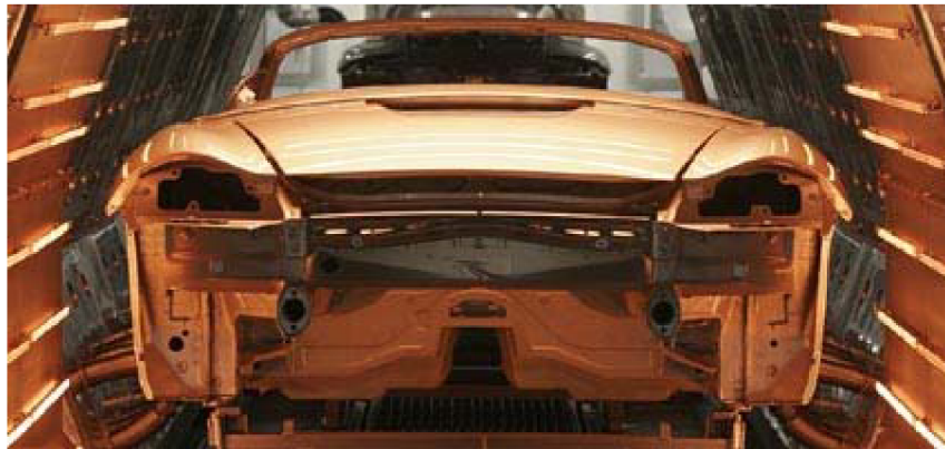
Obrázek 18: tvrzení laku v infračervené sušičce[9]
