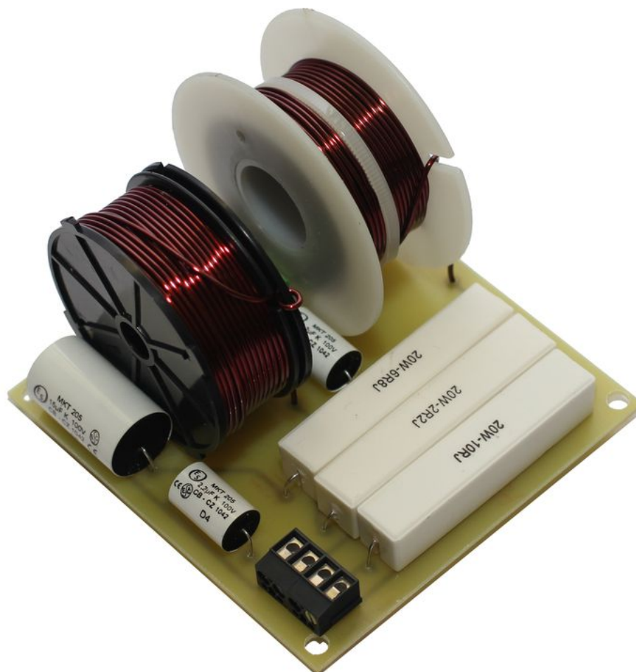
Obr. 5.4: Realizovaná výhybka dle konstrukčních podkladů.
