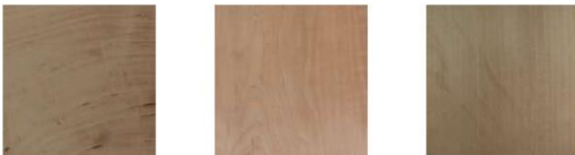
Obr. 1 Makroskopická struktura: příčný, tangenciální a radiální řez (Zeidler 2012)
