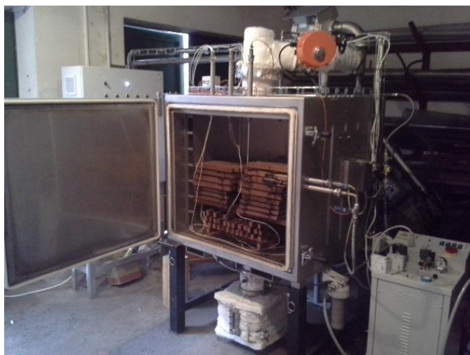
Obr. 10 Vzorky v termokomoře po úpravě (foto Tomáš Holeček)
