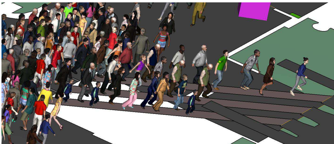
Obr. 71 – Zdržení osob na schodišti
