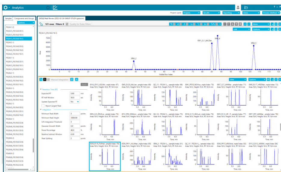
Obr. 31: Zobrazenie variability výsledkov chromatogramov v softvéri Sciex-OS. Výsledky LC-MS/MS analýzy lipidu PS (34:1) _PS(18:0/16:1) v podobe chromatogramov.
