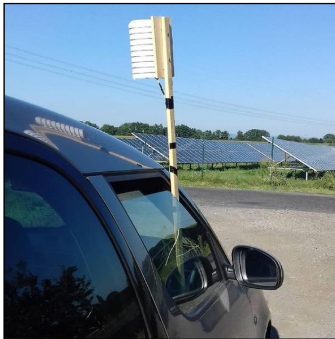
Obr. 5 Umístění teplotního čidla během měření.
