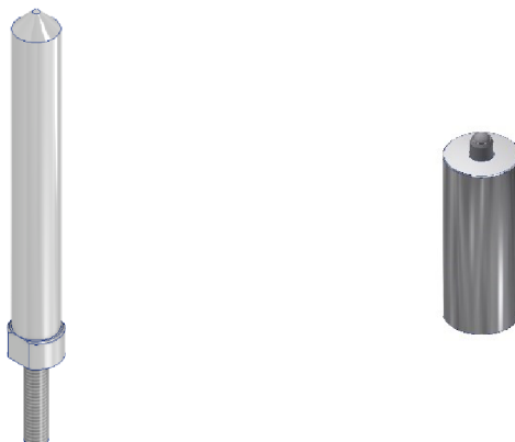
Obr. 16: Varianty podpěrných trnů: původní (vlevo) a nový (vpravo)
