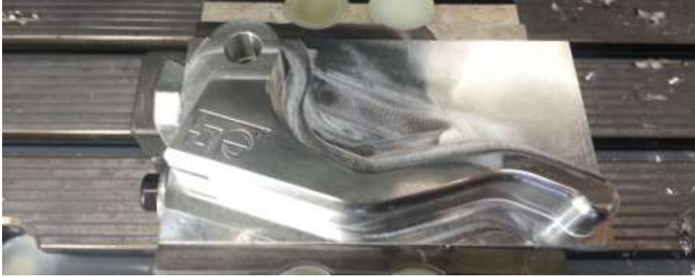
Obrázek 33: Stav součásti po obrábění z první strany
