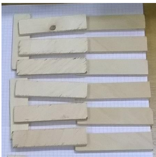
Obr. 22 Lepení břízy 45° (vlastní foto)
