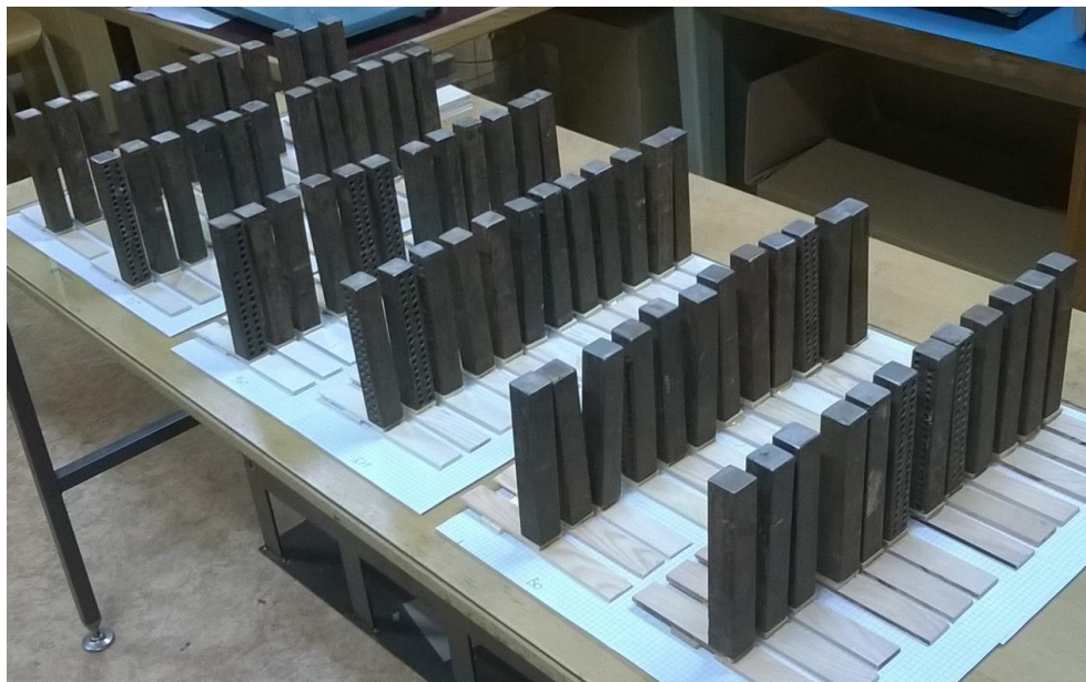
Obr. 4 Způsob lepení pomocí přeplátování (vlastní foto)
