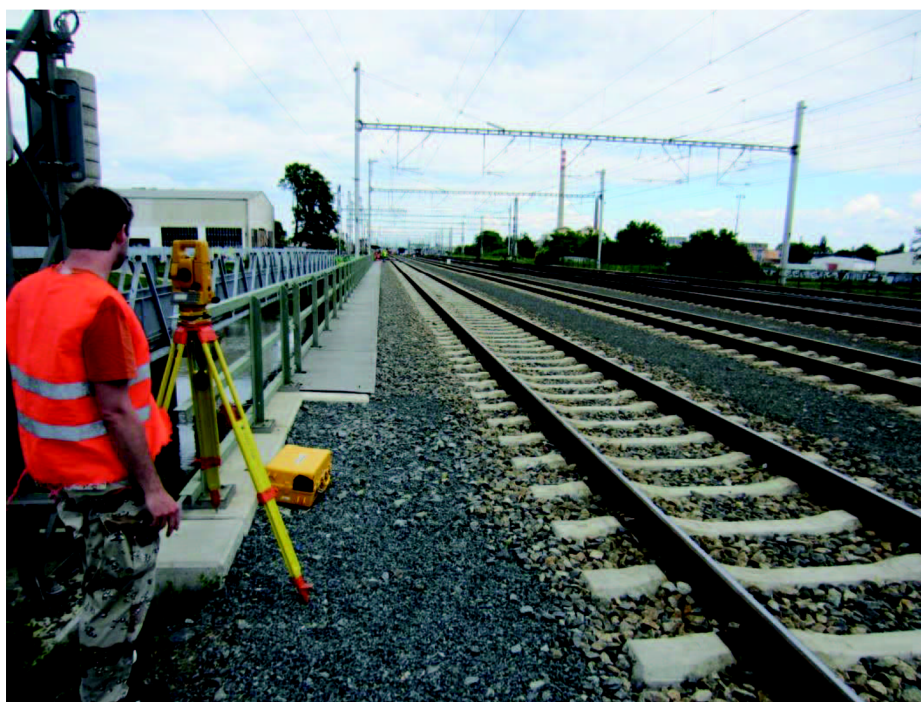
Obr. 4. 1 – totální stanice GPT – 6001N na stanovisku 200 sledovaného mostu
