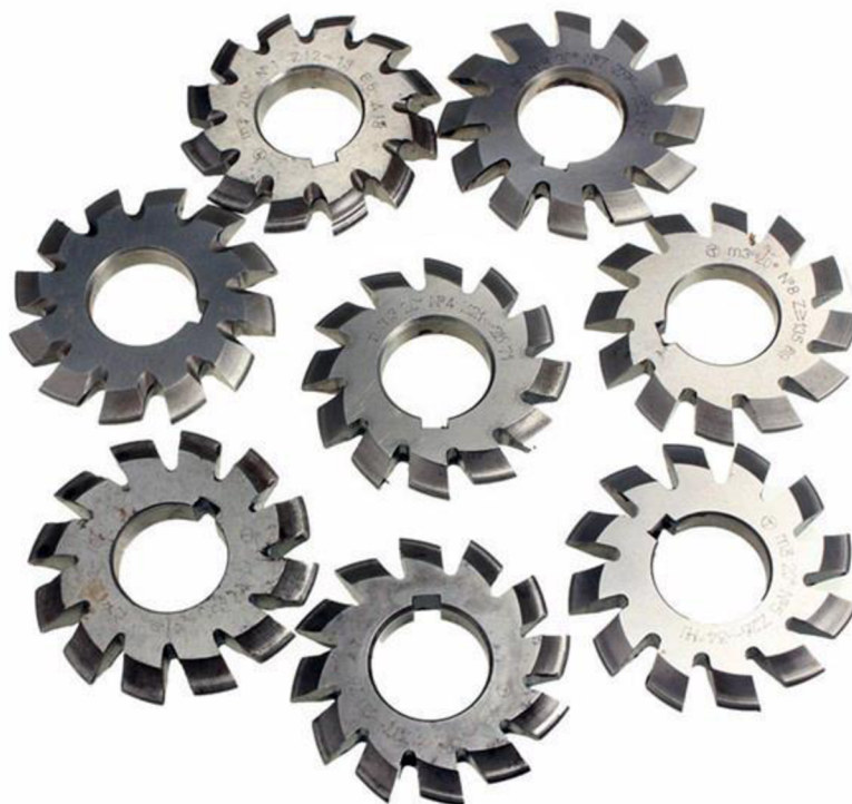
Obr. 2.5 Osmičlenná sada modulových fréz modulu 4 [22, 23].
