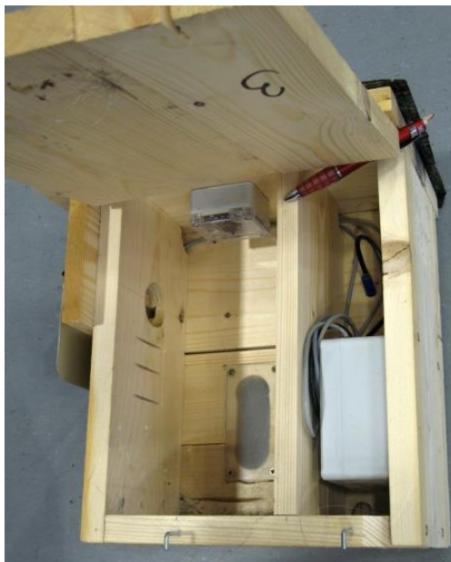
Obrázek 15. Chytrá ptačí budka (zdroj: http://www.zs-lysolaje.net/ptaci-budka-online/ ) Vlevo se nachází obytná část budky, zde je umístěna kamera s nočním přísvitem, mikrofon a teplotní čidlo.
