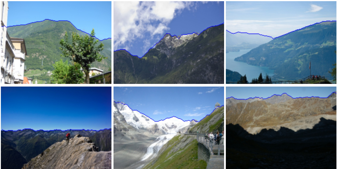
Obrázek 3.7: Ukázka extrahovaných křivek horizontu zpětným hledáním nejkratší cesty v kumulovaných hodnotách původní energetické mapy.
