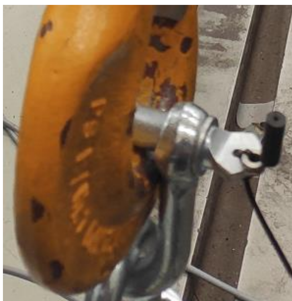
Obr. 39 Umístění oka lankového potenciometru předního stabilizátoru
