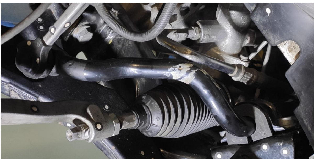
Obr. 13 Přední stabilizátor vozu Volkswagen Multivan připevněný na přední nápravě
