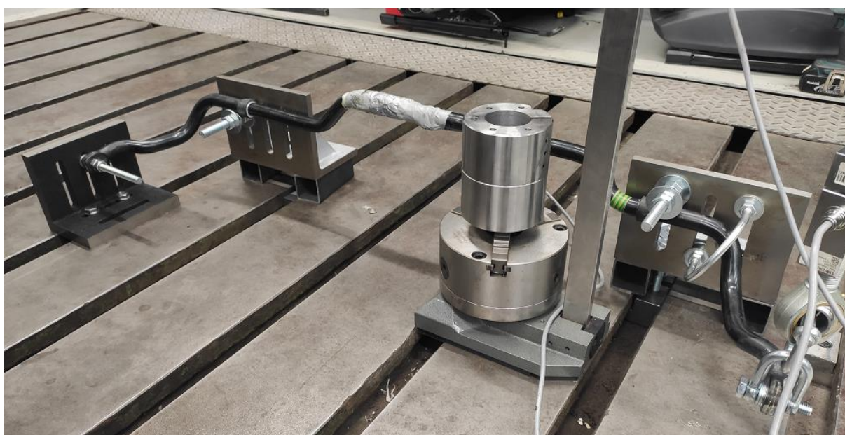
Obr. 33 Zkušební zařízení pro měření předního stabilizátoru bez silentbloků
