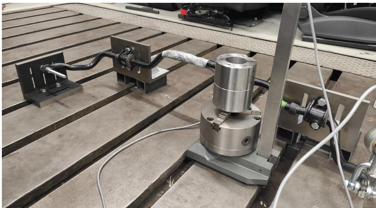
Obr. 32 Zkušební zařízení pro měření předního stabilizátoru se silentbloky
