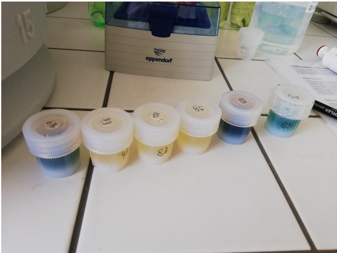
Obr. č. 4: Vzorčky po rozkladu za vysokého tlaku a teploty
