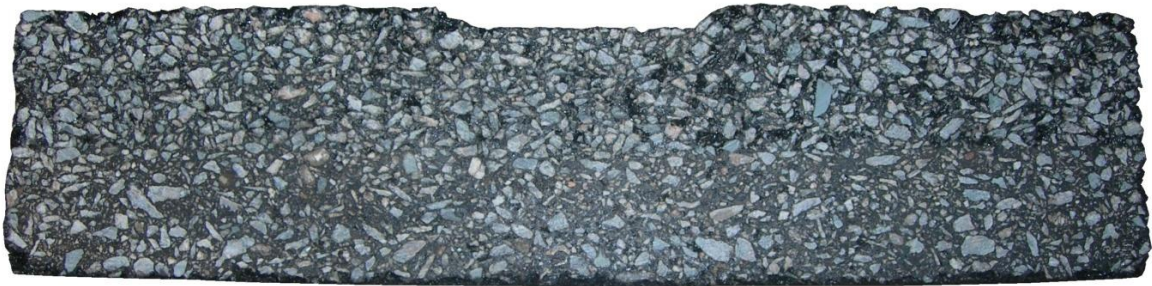
Obrázek 59: Řez souvrstvím Koliště 1 po zkoušce trvalých deformací
