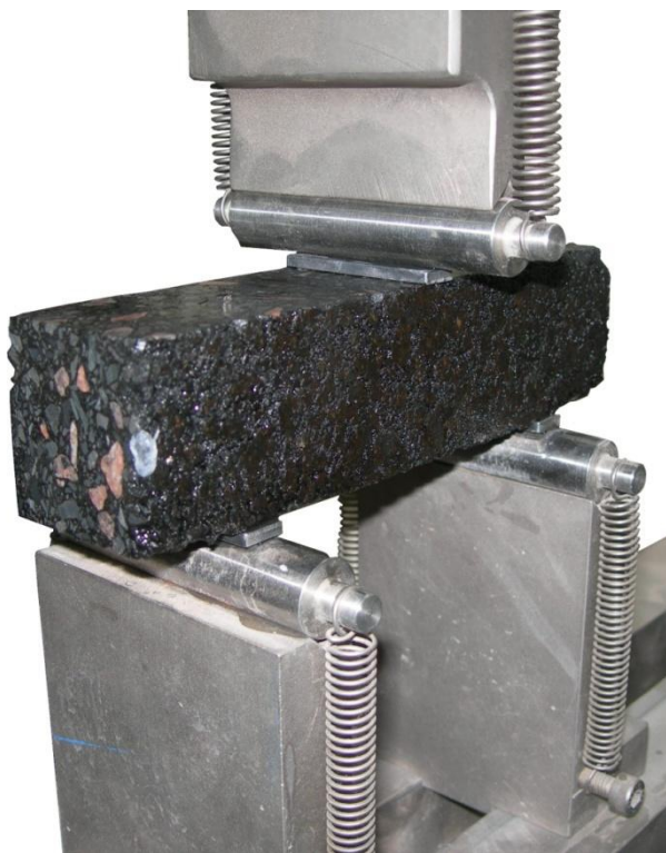
Obrázek 41: Čelisti včetně tlačného vzorku
