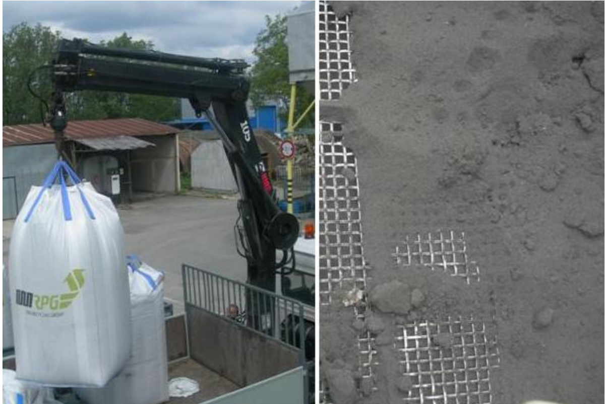
Obrázek 12: Velkoobjemový pytel s pryžovým granulátem, který je pomocí zvedacího zařízení zvedán do násypky
