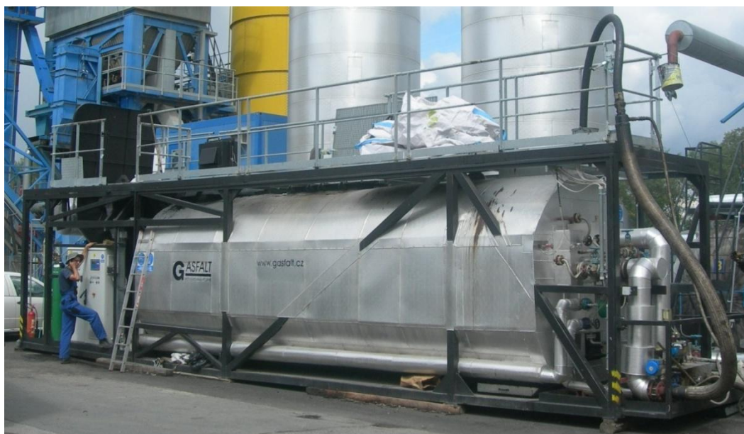
Obrázek 11: Mísící zařízení G-ASFALT
