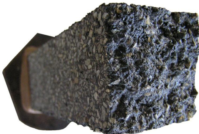
Obrázek 67: Příklad porušeného tělesa po zkoušce nízkoteplotních charakteristik směsi
