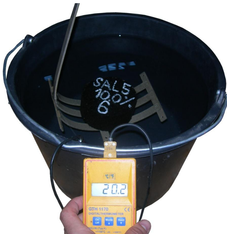
Obrázek 49: Vážení na hydrostatických vahách v destilované vodě
