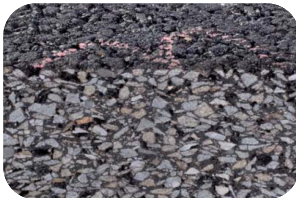
Obrázek 14: Směs BBTM B 5, Zdroj: G-ASFALT
