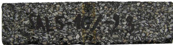
Obrázek 61: Zkušební vzorek na zkoušku v tahu za ohybu, směs 2, 10 % pojiva
