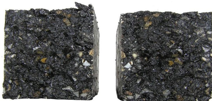
Obrázek 62: Lom na zkušebním tělese, směs 2, 10 % pojiva
