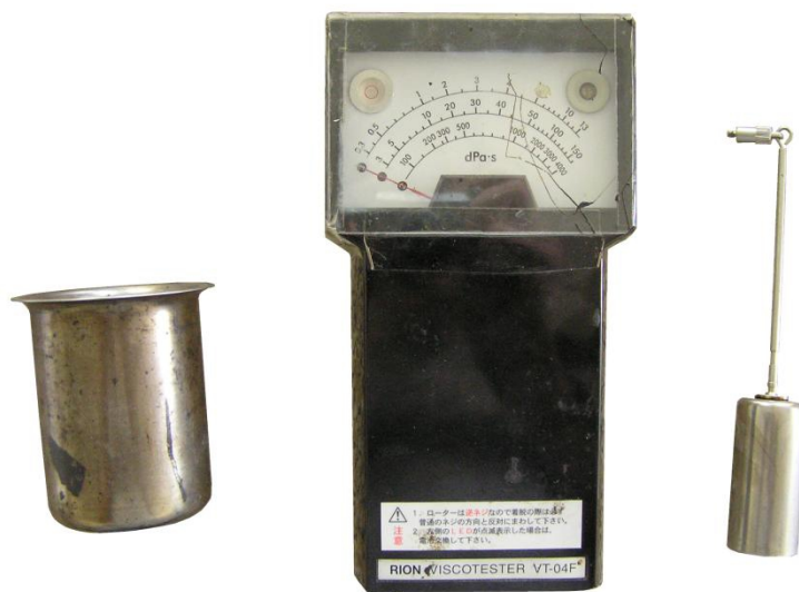
Obrázek 28: Viskozimetr, nádobka na vzorek a rotační vřeteno
