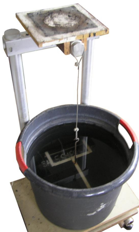
Obrázek 35: Vážení zkušební desky ve vodě
