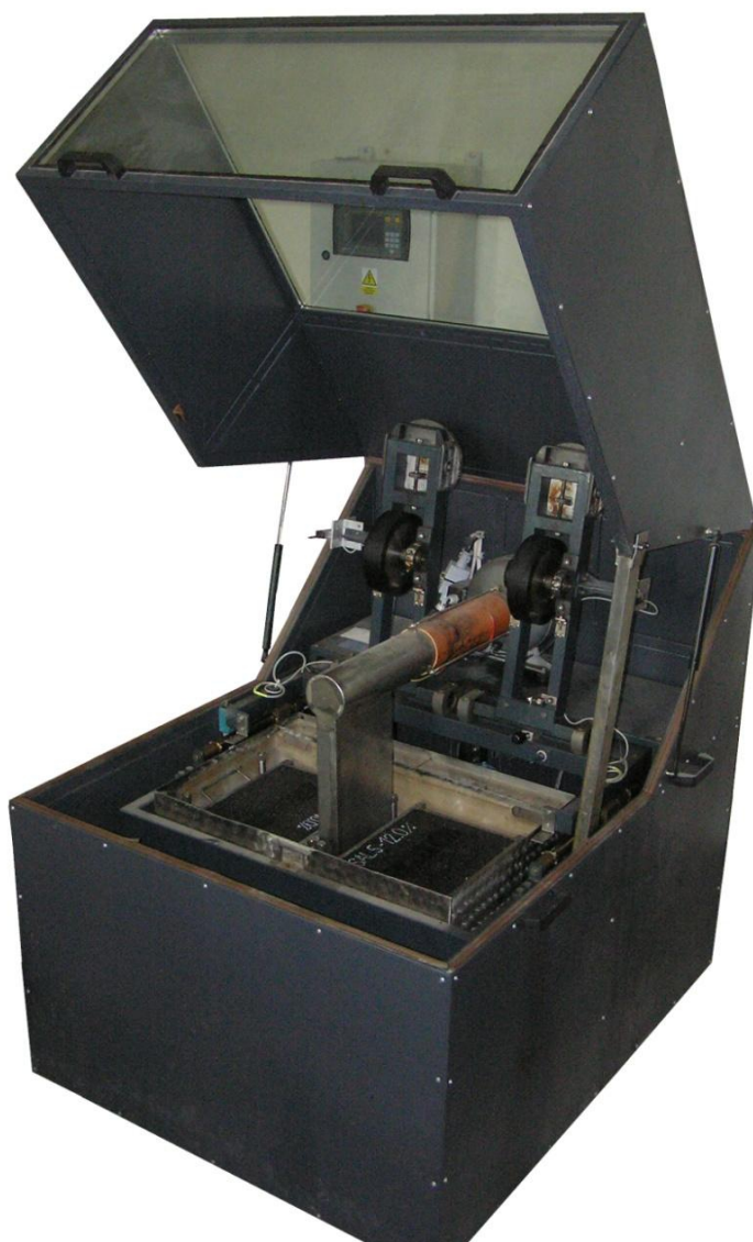
Obrázek 37: Zařízení na zkoušku pojíždění kolem
