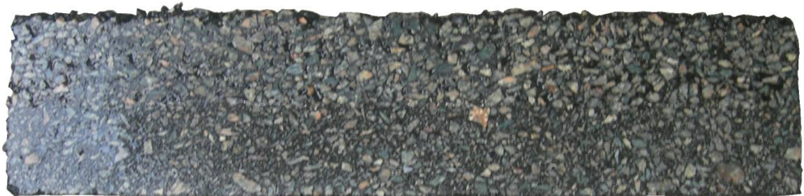
Obrázek 60: Řez souvrstvím Koliště 2 po zkoušce trvalých deformací
