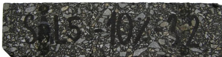
Obrázek 65: Zkušební vzorek na zkoušku v tahu za ohybu, směs 3, 10 % pojiva
