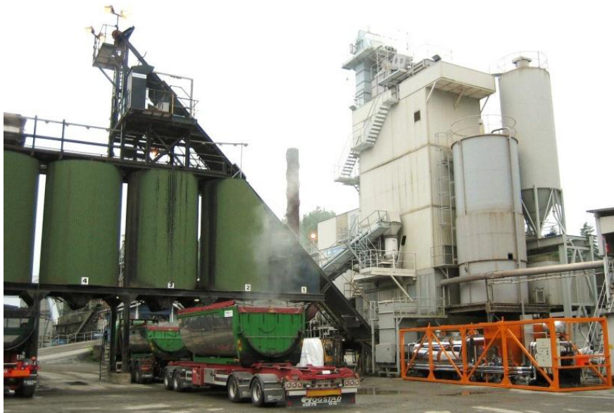
Obrázek 9: Připojení mísícího zařízení AR 150M k obalovně Skanska poblíž Jonkopingu ve Švédsku, Zdroj: Phoenix Industries
