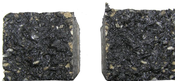
Obrázek 64: Lom na zkušebním tělese, směs 2, 12 % pojiva
