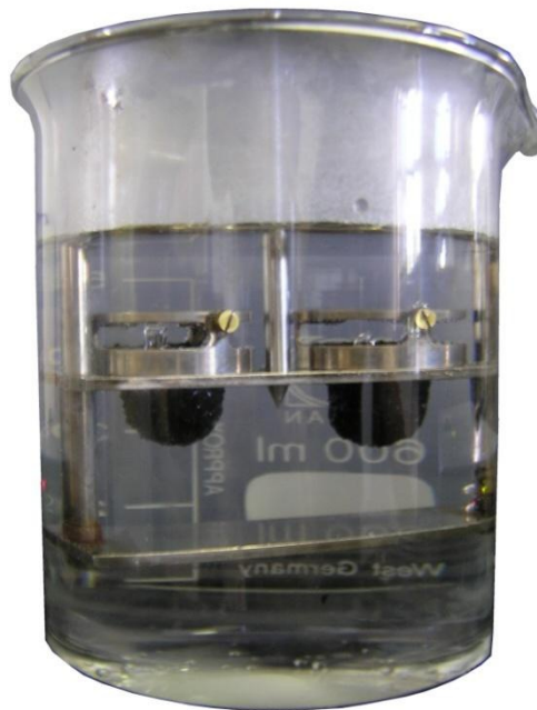
Obrázek 27: Protážení pojiva modifikovaného pryžovým granulátem
