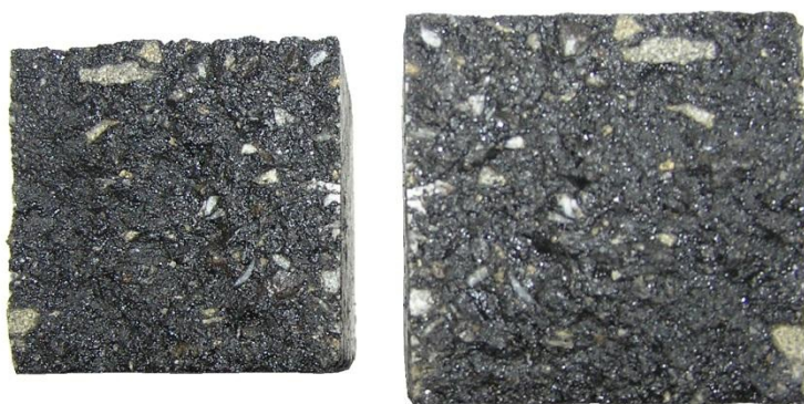
Obrázek 66: Lom na zkušebním tělese, směs 3, 10 % pojiva
