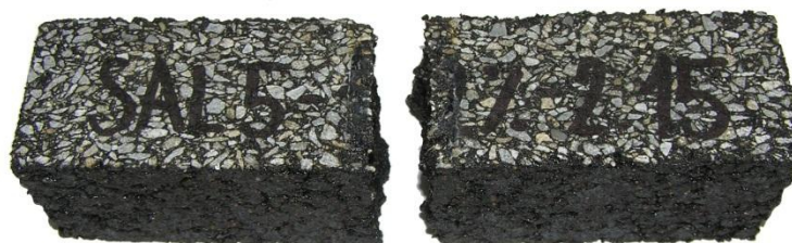
Obrázek 63: Zkušební vzorek na zkoušku v tahu za ohybu, směs 2, 12 % pojiva
