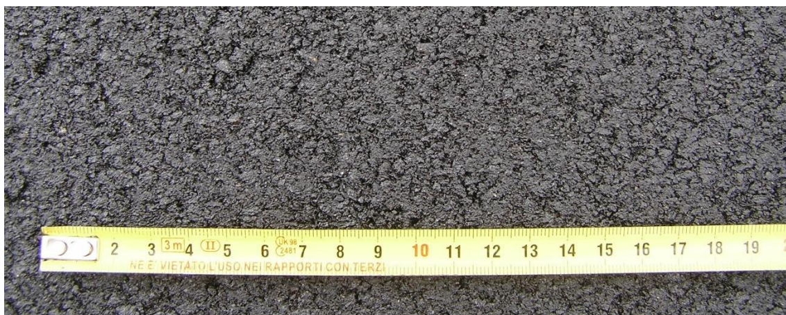
Obrázek 78: Detail vrstvy SAL dle návrhu diplomové práce
