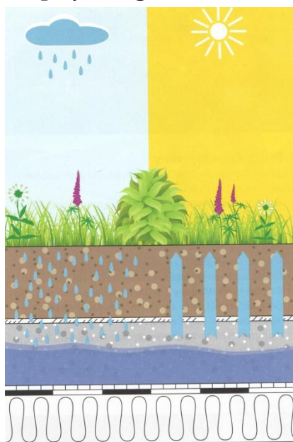
Obr. 18: Princip hydrologické bilance u vegetační střechy
