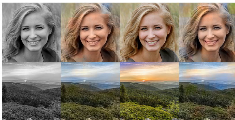
Obrázek 7.4: Porovnání výstupů prvního modelu (trénovaného na celém datasetu) s originálním obrázkem (zleva černobílý obrázek, kolorovaný obrázek ze sedmé epochy, originální obrázek, kolorovaný obrázek z třicáté epochy)
