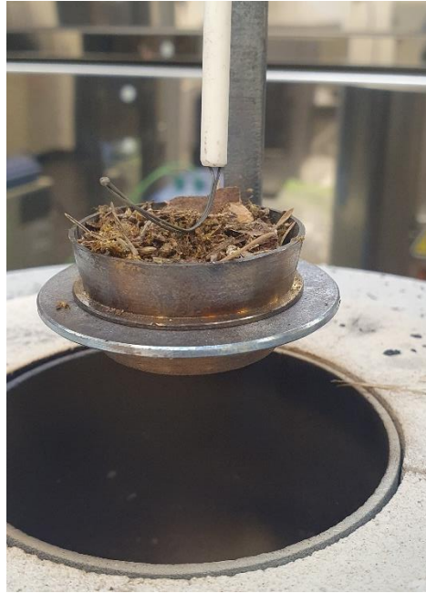
Obrázek 14: Termočlánek teploty vzorku (foto. A. Makarová)
