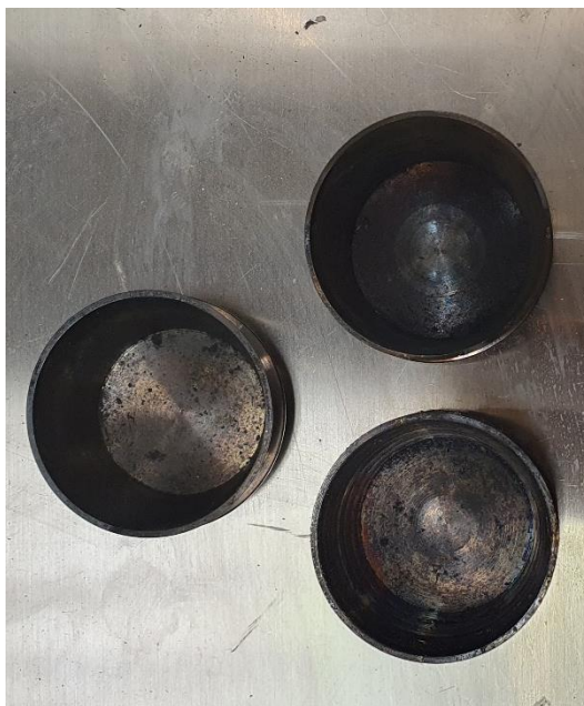
Obrázek 8: Laboratorní kalíšky na vzorky (foto. A. Makarová)
