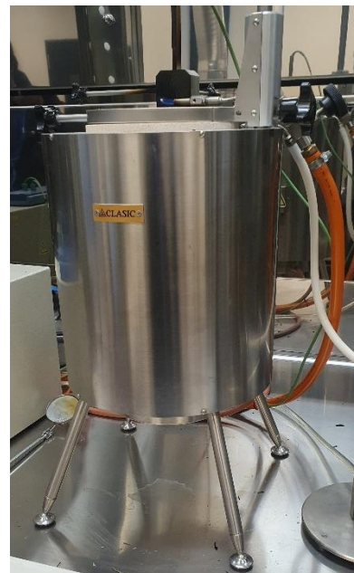
Obrázek 9: Setchkinova odporová pec (foto. A. Makarová)
