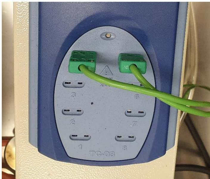
Obrázek 16: Záznamník hodnot (foto. A. Makarová)
