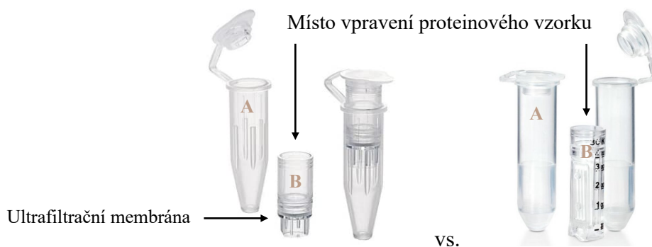
Obr. 7: Komerčně dostupné ultrafiltrační jednotky. Vlevo: "Microcon", Vpravo: "Amicon Ultra". A – svrchní část jednotky, B – spodní část jednotky. Staženo z https://www.ubuy.mv/en/ ; https://www.fishersci.se/se/en/home.html .
