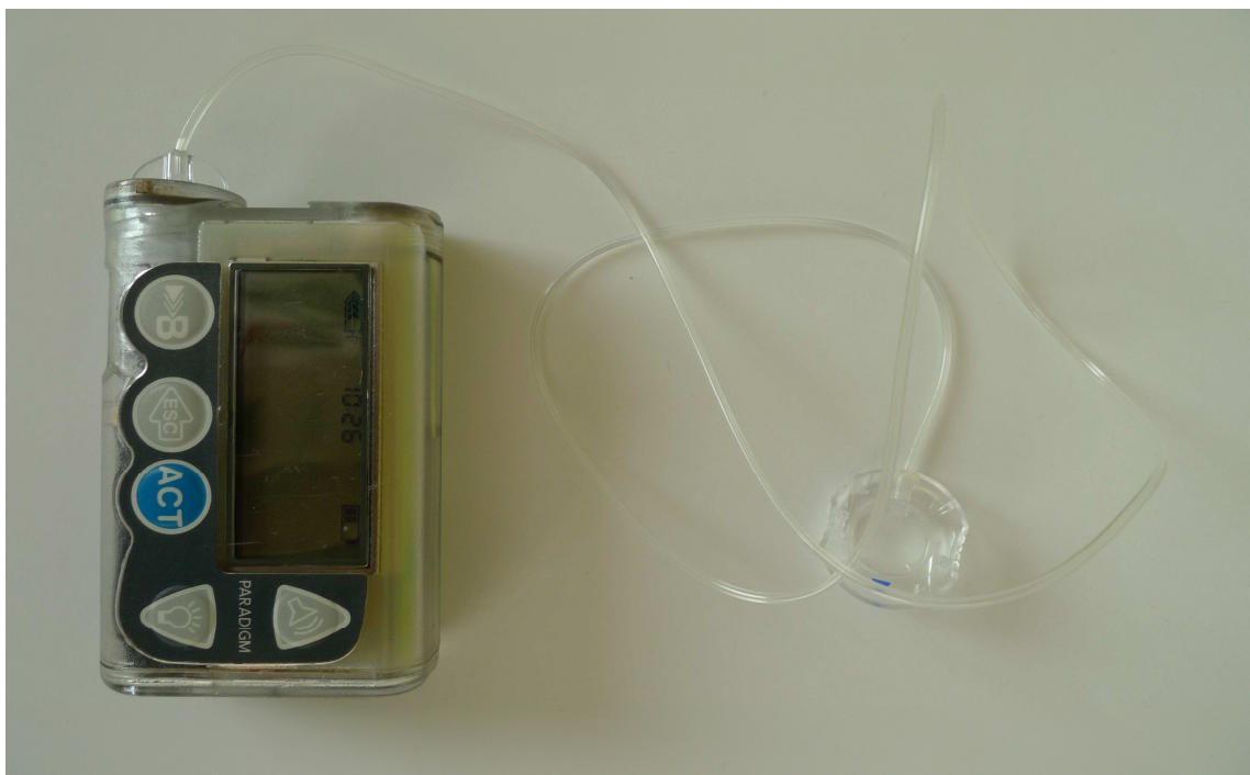
Fotografie 2. Inzulínová pumpa, slouží k permanentní aplikaci inzulínu.
