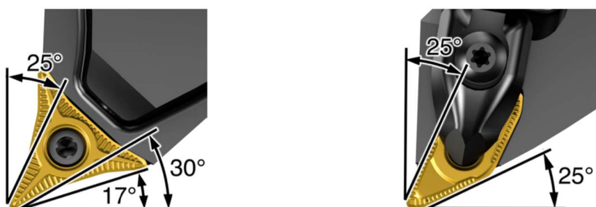
Obr. 3.13 Úhly nastavení nástrojů určených pro soustružení metodou PrimeTurning [20].
