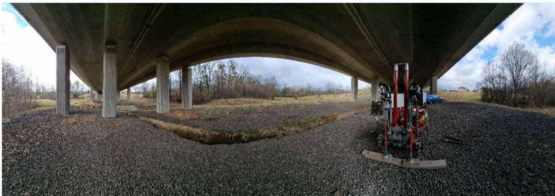
Obrázok č. 4.2: Prebiehajúca skúška CPT pri mostnom objekte C203
