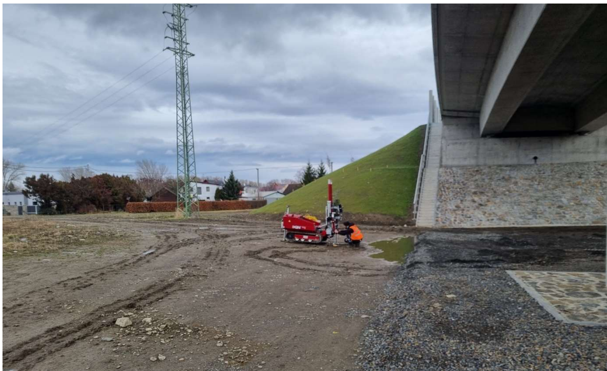
Obrázok č. 4.1: Prebiehajúca skúška CPT pri mostnom objekte C202
