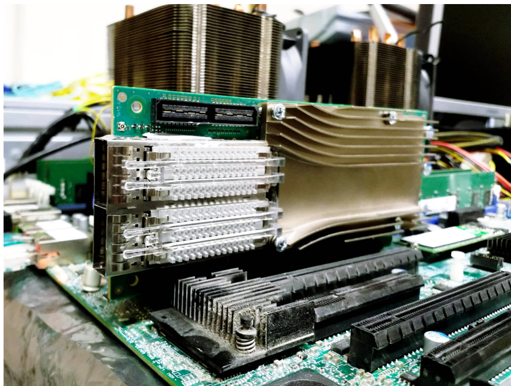
Obr. 1.3: Síťová karta COMBO-200g2ql vyvinutá sdružením CESNET
