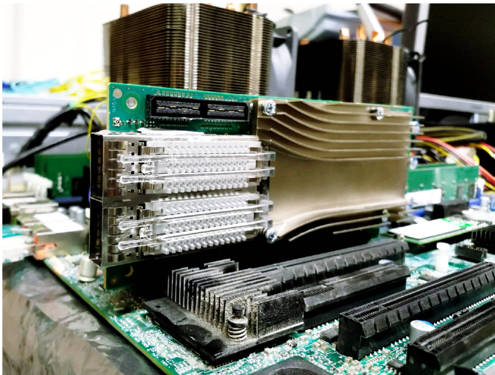
Obr. 1.3: Síťová karta COMBO-200g2ql vyvinutá sdružením CESNET
