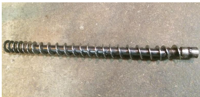
Obr. 42 Zkroucení podávacího šneku při dávkování TAP 1
