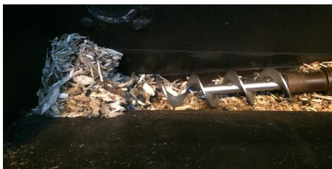
Obr. 43 Nový šnek s upravenou geometrií a délkou
