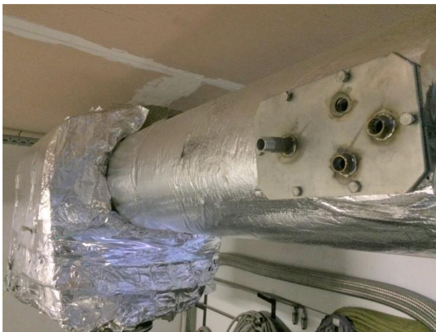
Obr. 9 Umístění druhého měřicího bodu pro stanovení TZL ve spalinách mezi usazovací komorou a trubkovým chladičem
