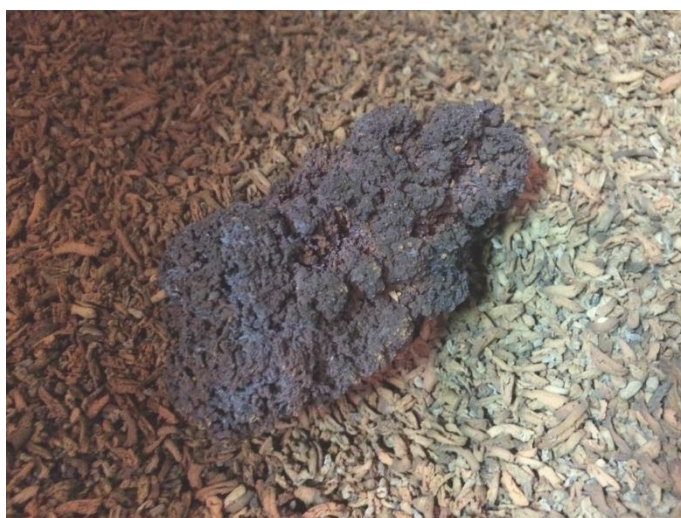
Obr. 44 Aglomeráty (až 12 cm dlouhé) v popelu při spalování KAL 1
