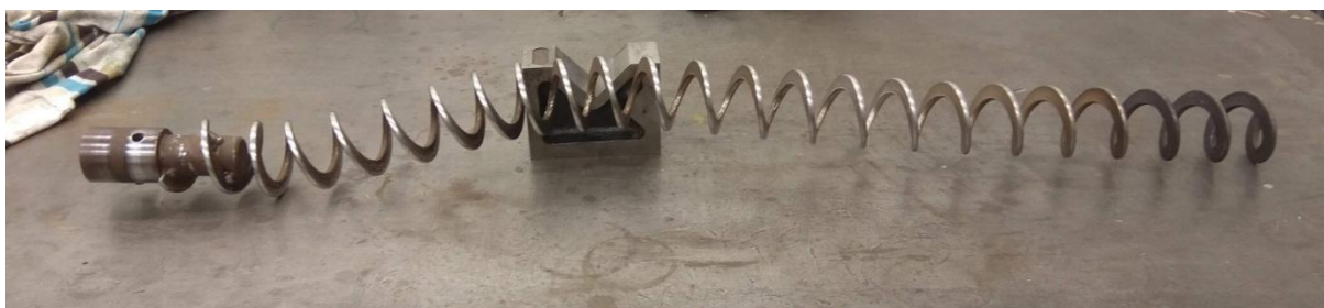
Obr. 41 Ohnutí šneku v podávací trubce při dávkování lesního odpadu
