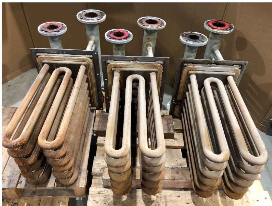
Obr. 59 Stav segmentů chladiče spalin po spalovacích zkouškách (směr proudění spalin byl zprava doleva)
