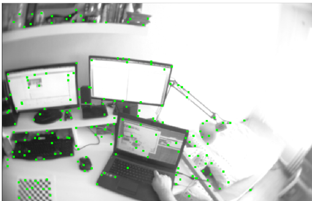
Obrázek 3.7: Metoda SVO při běhu v místnosti s rušivým elementem v podobě slunečního záření přicházejícího zprava skrze okno.
