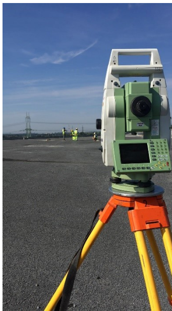
Obr. 3 Totální stanice Leica TPS 1200+
