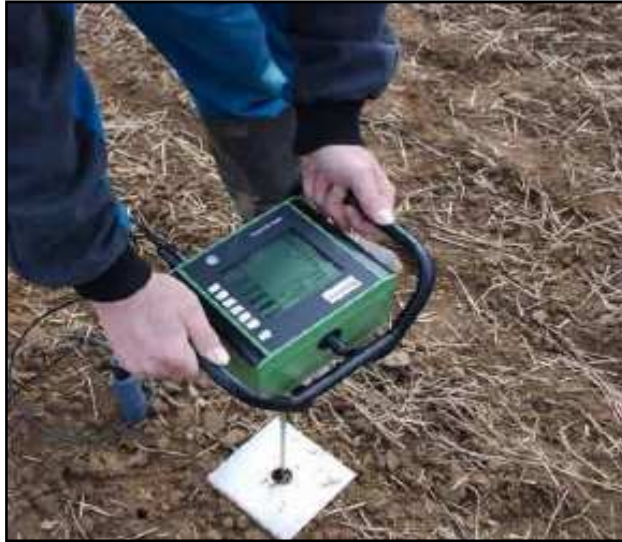
Obrázek 4: Měření penetračního odporu ručním penetrometrem (Lukas, 2011)
