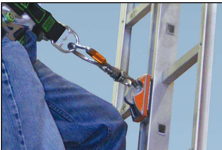
Obr. 3.3 Žebřík s bezpečnostní lištou a zachycovačem pádu.
