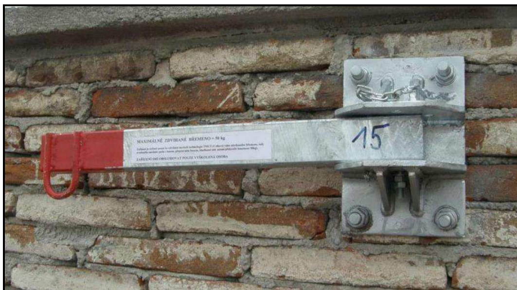
Obr. 3.6 Konstrukce pro transport materiálu.
