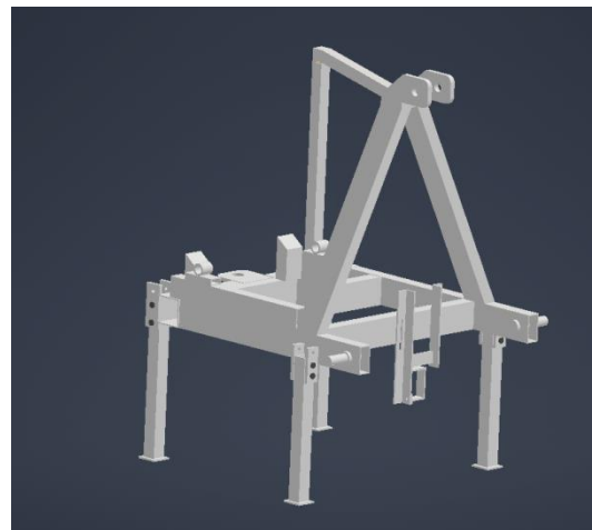
Obr. 3.7 Svařený rám štěpkovače
