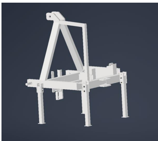
Obr. 3.7 Svařený rám štěpkovače
