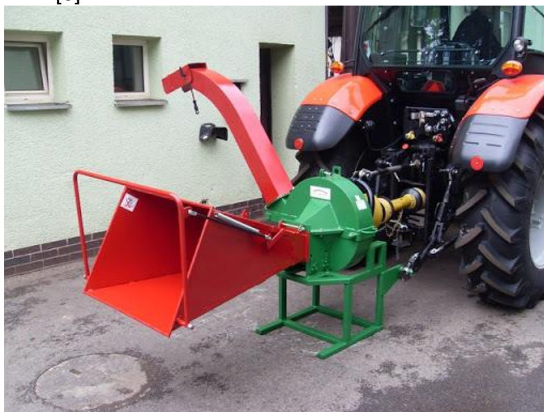
Obr. 1.9 Štěpkovač poháněný traktorem, Pirba [8]
