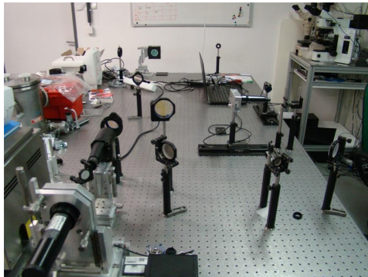
obr. č. 39 Schéma a experimentální realizace aparatury pro korekci optických vad s využitím PDM řízeného GA
