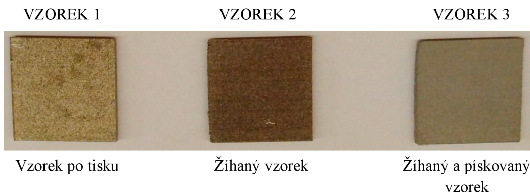
Obrázek 2: Vzorky vyrobeny metodou SLM. Převzato a upraveno z [12].
