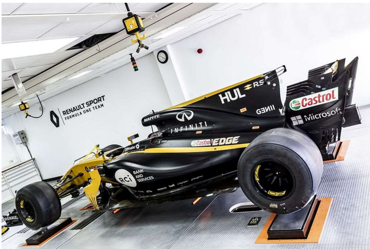
Obr. 27 Monopost F1 z roku 2017, Renault RS17, na 7-bodovom testovacem zariadení [33]
