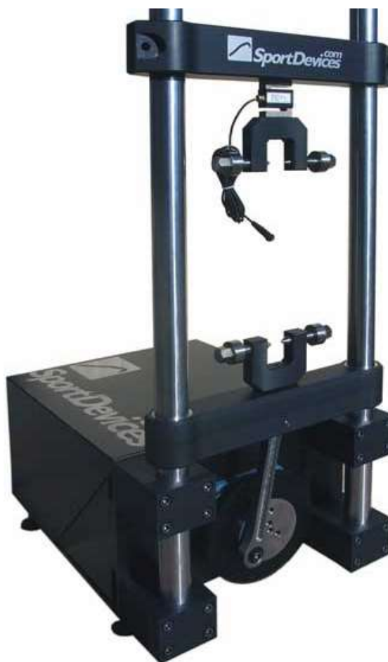
Obr. 19 Kľukový mechanický dynamometer [20]
