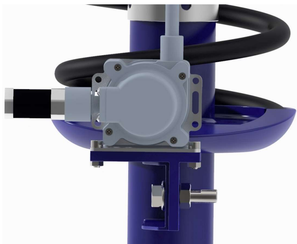
Obr. 48 Detail na potenciometer a jeho pripevnenie o „T“ časť
