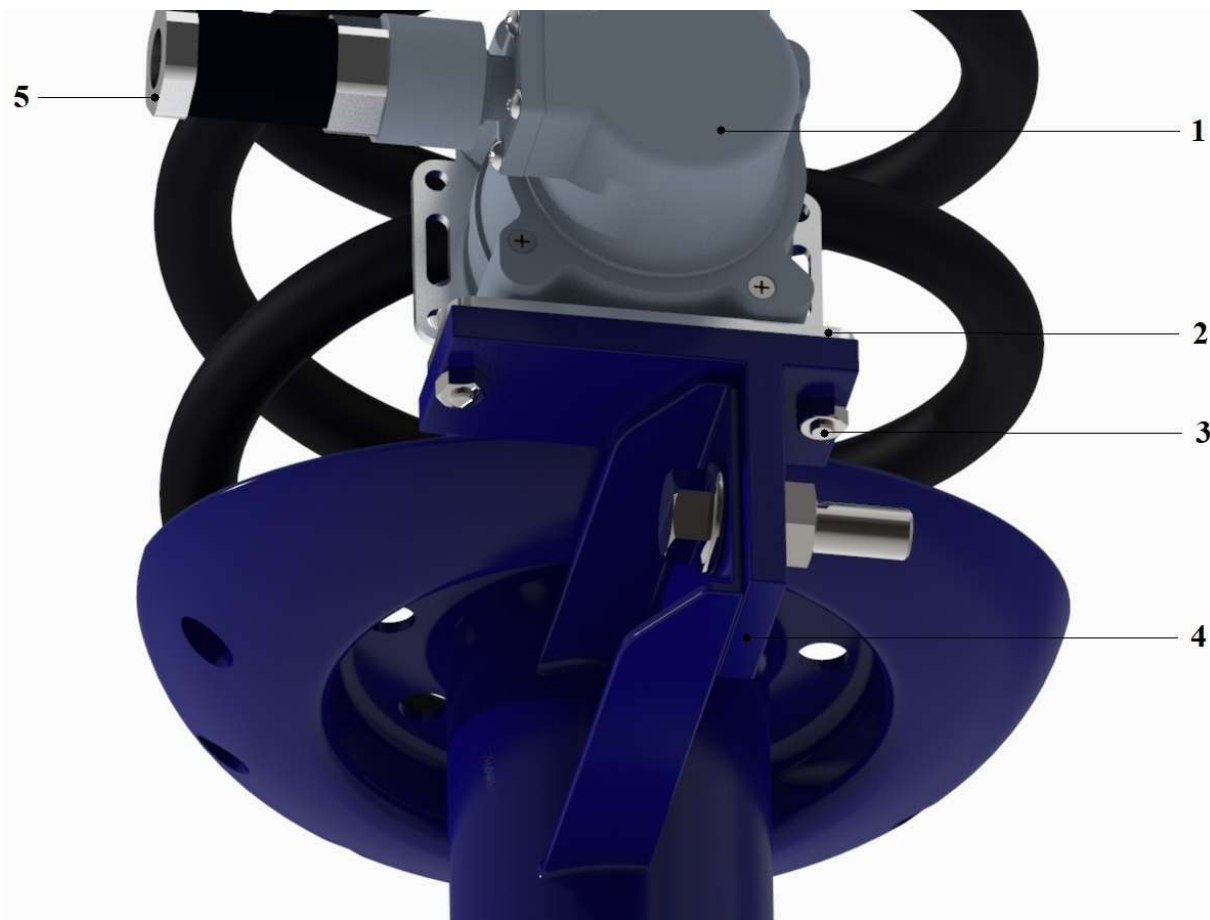
Obr. 49 Popis spodného uchytenia lankového potenciometru
