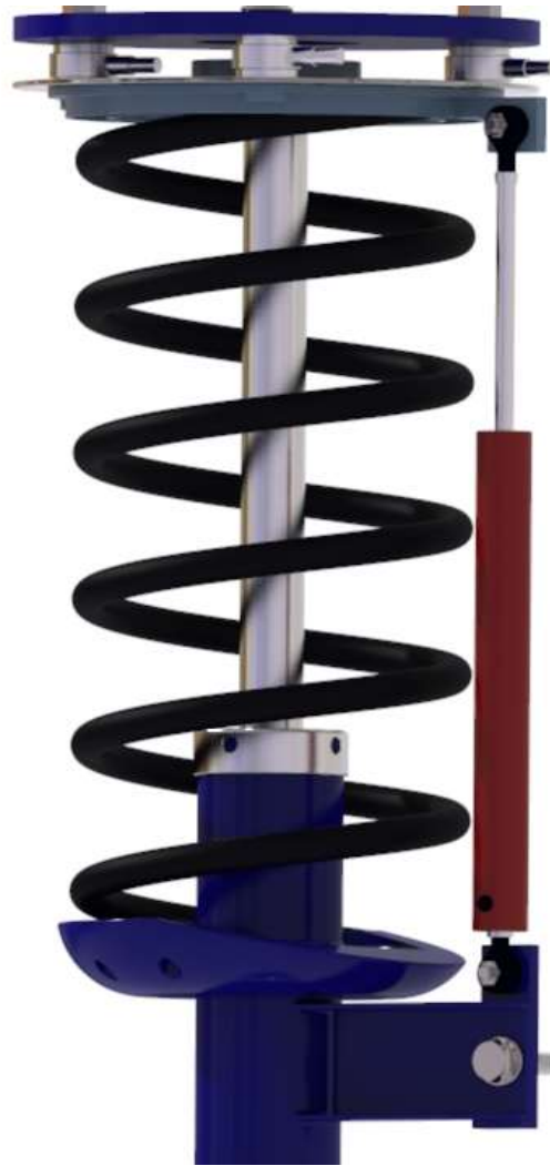
Obr. 43 Pohľad na umiestnenie LVIT snímača
