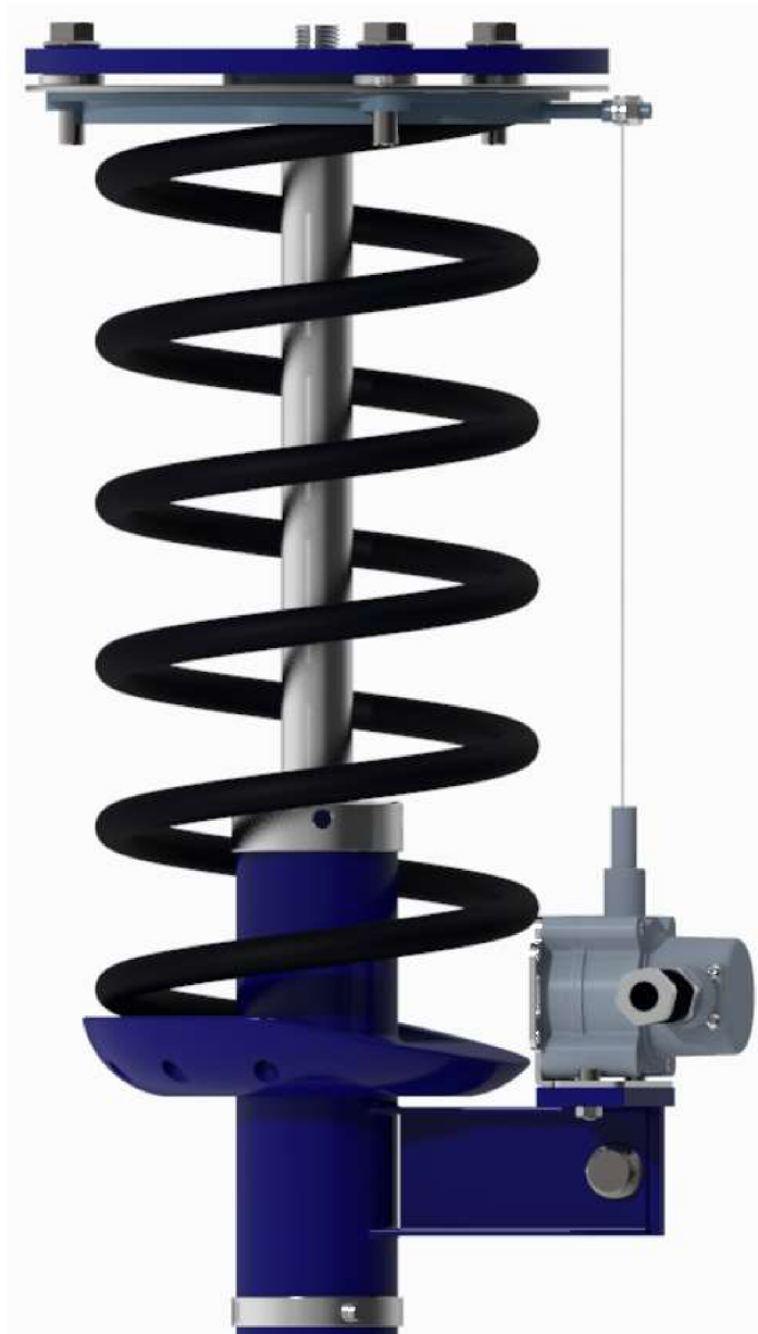
Obr. 46 Pohľad na umiestnenie lankového potenciometra
