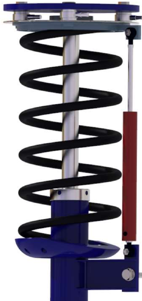
Obr. 43 Pohľad na umiestnenie LVIT snímača
