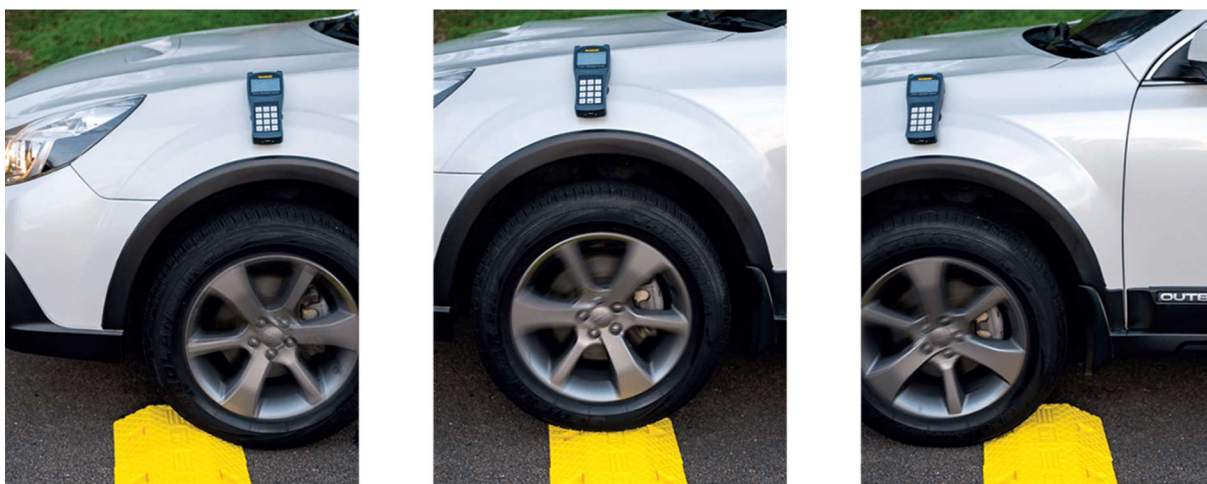
Obr. 25 Test tlmiča pomocou testovacieho zariadenia od firmy Monroe [29]
