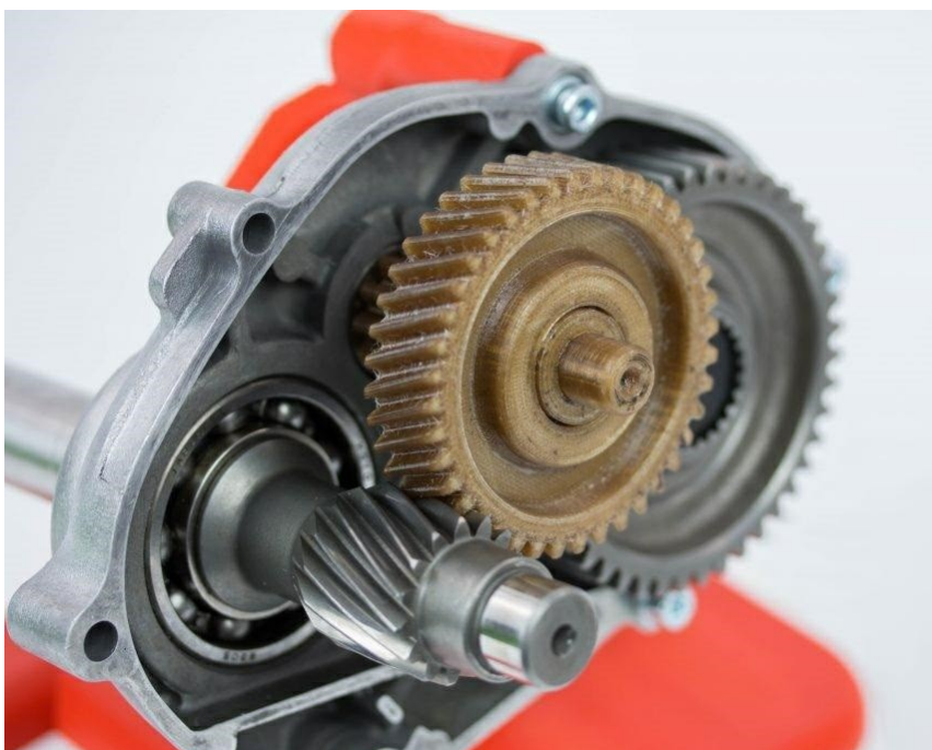
obr. 3.7.4-1 Převodovka s šikmými zuby, vložené kolo z PEEK; [34].
