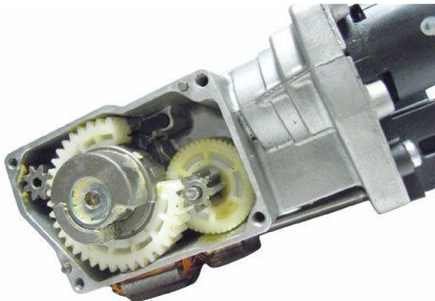
obr. 3.8.4-3 Mechanismus elektrické parkovací brzdy BMW E65; [22].
