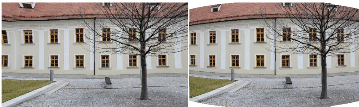
Obrázek 4.3: Spojené cylindrické snímky: vlevo k_1 = -0,2 a k_2 = -0,2 , okraje výsledného snímku jsou již příliš rozmazané a zkreslené; vpravo: k_1 = 0,2 a k_2 = -0,2 spojené snímky jsou vůči sobě mírně posunuty, jak lze vidět na okapové rouře přibližně uprostřed snímku.
