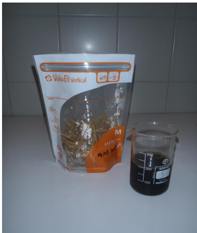
Obr. č. 9 Sterilní nádoba se slámou a průsaková voda ze skládky (Ciencialová, 2016)
