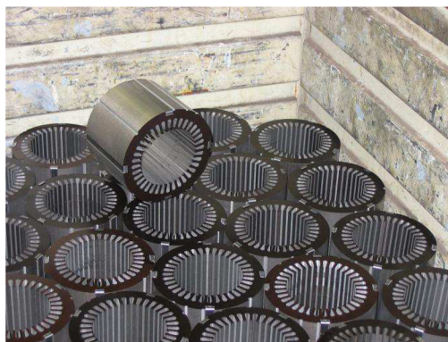
Obr. 9 Nenavínutý statorový svazek [18].
