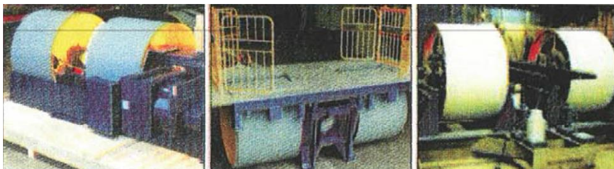
Obr. 31 Valcové dynamometre podľa umiestnenia motora: motor v jednej rade (vľavo), motor v strede, motor vo valci (vpravo) [16]
