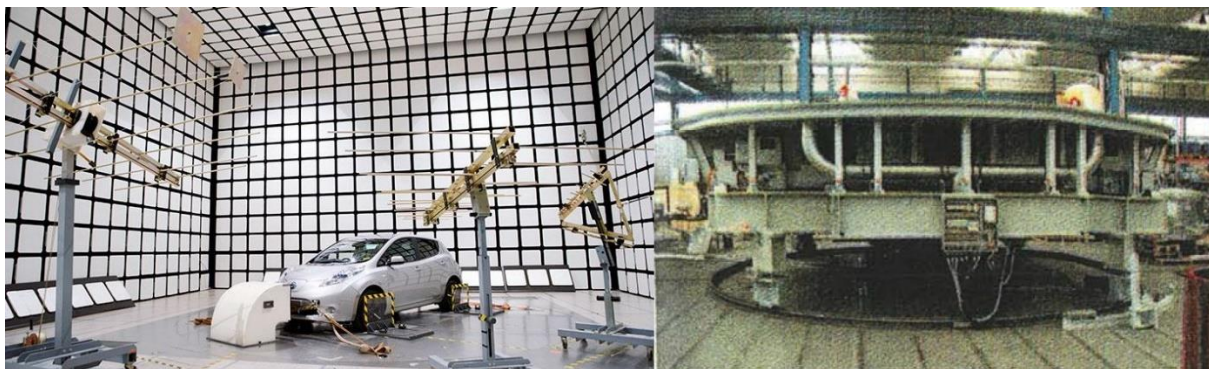
Obr. 34 Príklad EMC testu (vľavo) a detail otočného valcového dynamometra (vpravo) [16, 27]
