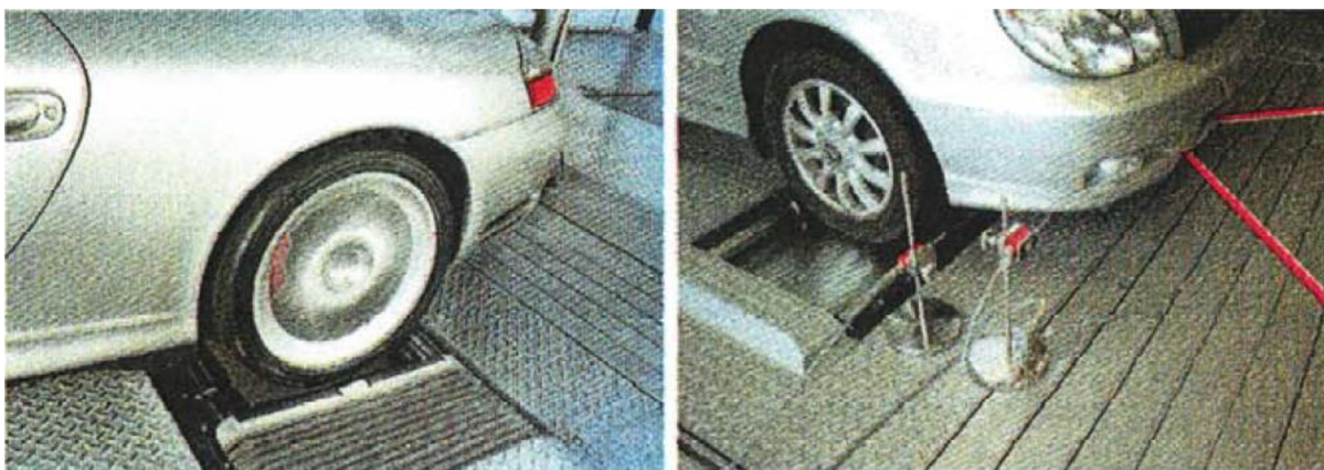
Obr. 17 Kryty valcov (vľavo) a zariadenia pre monitorovanie polohy vozidla (vpravo) [16]
