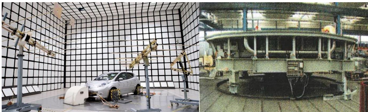
Obr. 34 Příklad EMC testu (vľavo) a detail otočného valcového dynamometra (vpravo) [16, 27]
