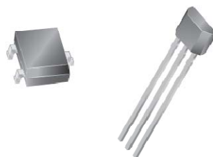
Obrázek 3.5 Pouzdra, ve kterých se sonda dodává, a) SOT23, b) TO92UA.
